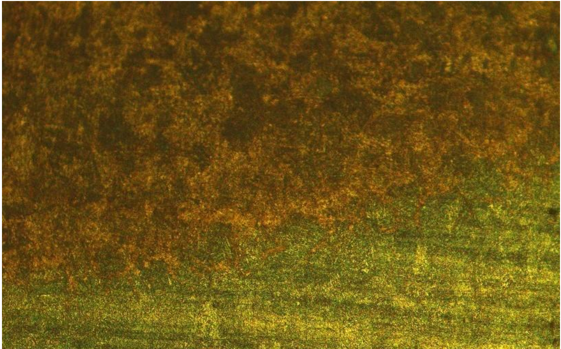
44. ábra 3mm/s sebességgel edzett 1.2767 mikroszkópi képe 100X nagyításban
