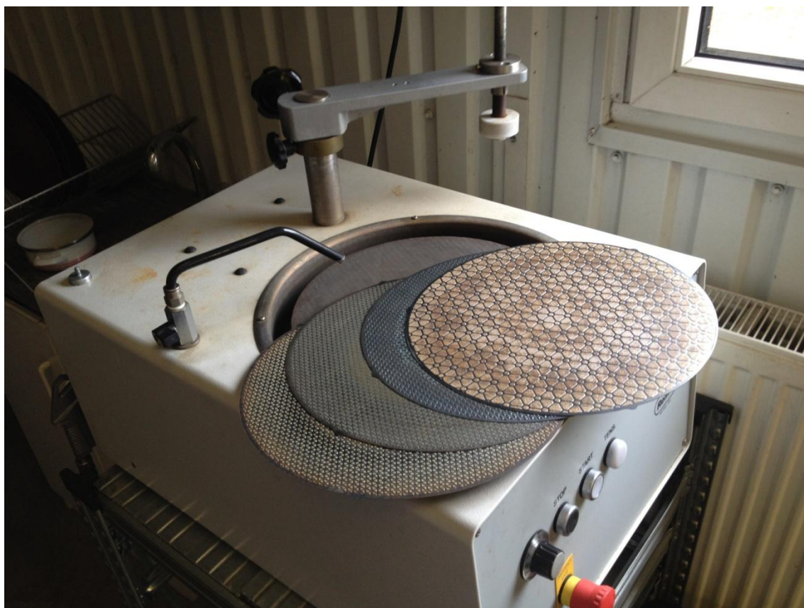
28. ábraRemet LS3V egytárcsás csiszoló-polírozó gép és csiszoló tárcsák
